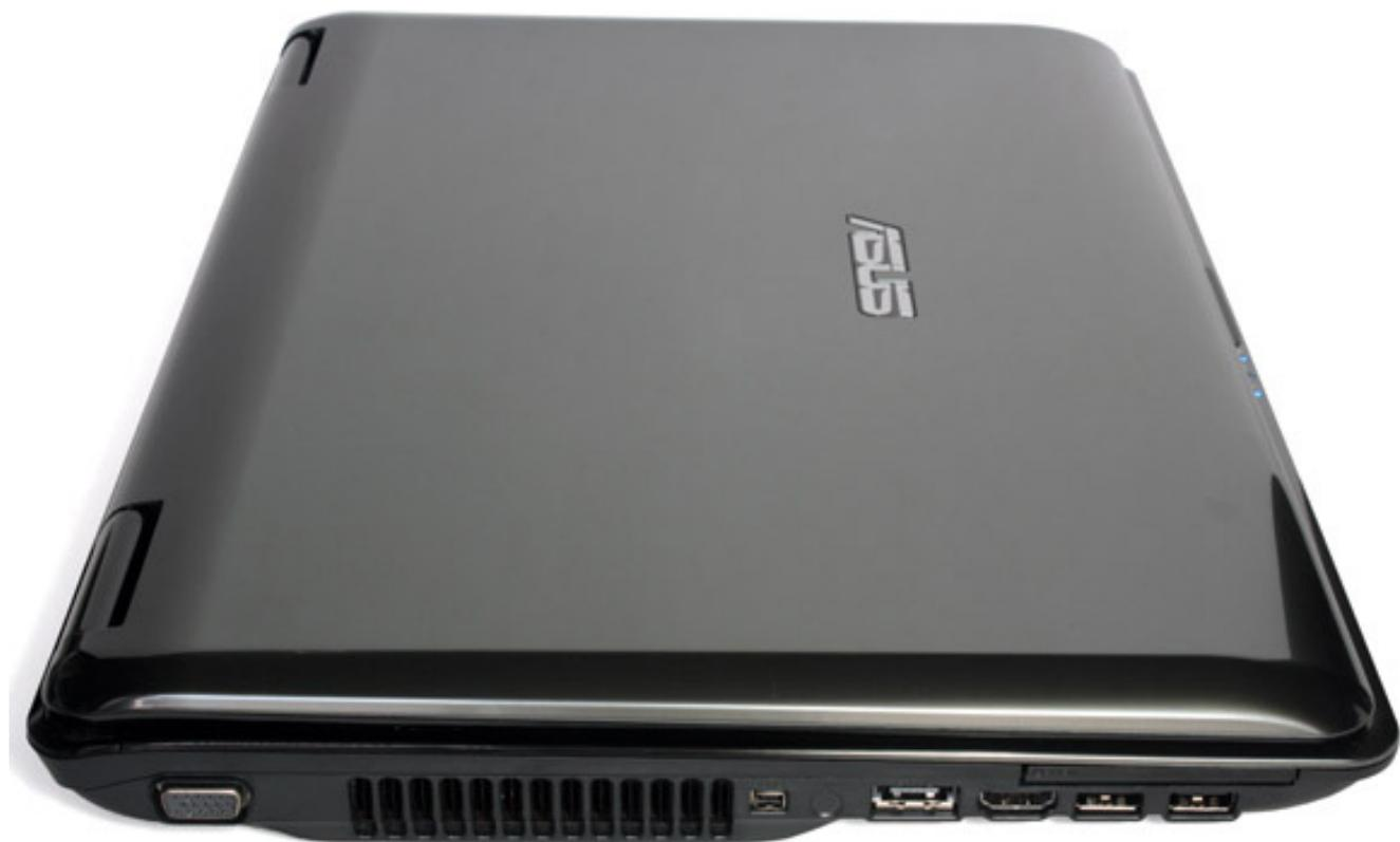
**Lato destro:** Questo lato è stato utilizzato principalmente per il lettore ottico, tuttavia c'è posto per i 3 jack da 3.5mm (comprendono l'interfaccia digitale S/PDIF) e due delle quattro porte USB 2.0.
